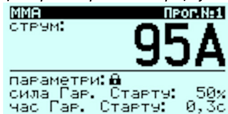
Дисплей джерела струму під час MMA-зварювання
